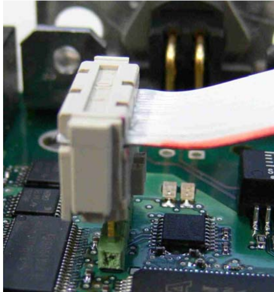
Abbildung 4-1 Darstellung Stecker auf Stiftleiste
